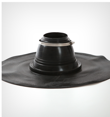
Gummistos, papptak (ink rostfri slangklämma) För rörgenomföring genom papptak. Monteras med asfaltskliester. Art.nr. 900 030 Pris: 410 kr
