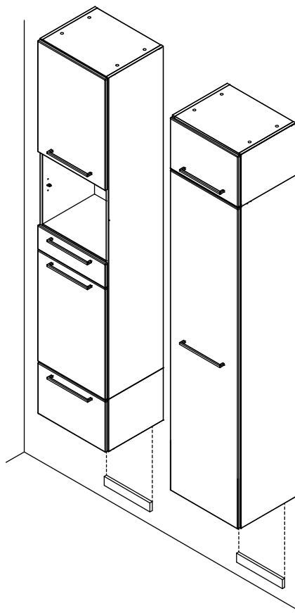
Nosta kaappi tukilistan päälle ja kiinnitä seinään kaapin takaosassa olevien sidelistojen läpi.
