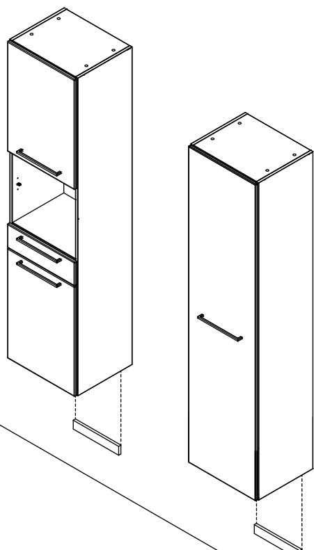
Nosta kaappi tukilistan päälle ja kiinnitä seinään kaapin takaosassa olevien sidelistojen läpi. Kiinnikkeet eivät sisälly toimitukseen.
