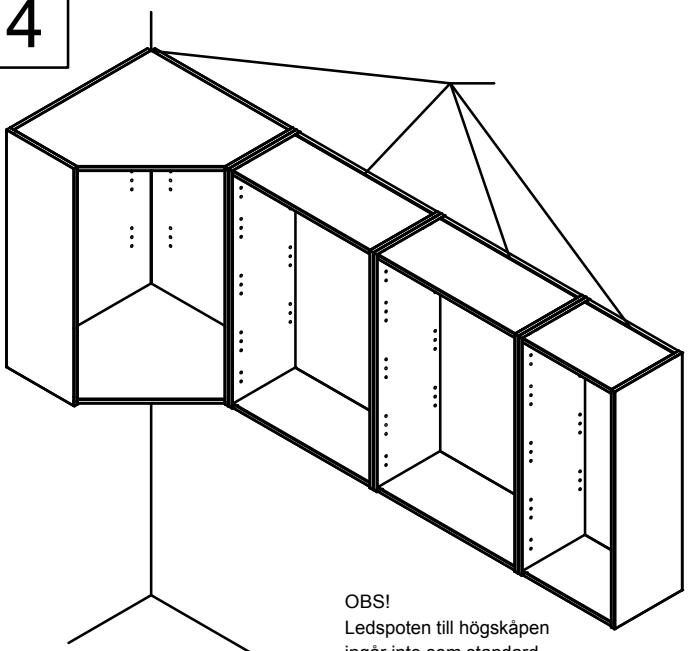
Nosta seinäkaapit seinälle asennuslistan päälle ja kiinnitä ne seinään kaappien takaosassa olevien sidelistojen läpi. Kiinnikkeet eivät sisälly toimitukseen.
