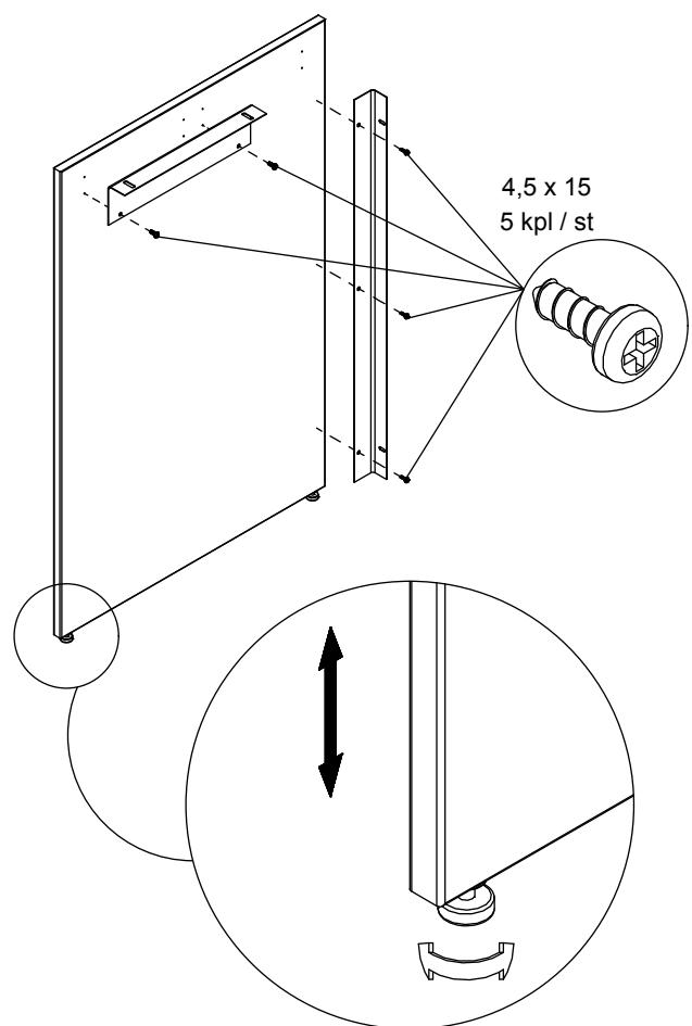
Asenna irtosivu seinämateriaalin mukaisilla kiinnikkeillä seinään. Kiinnikkeet eivät sisälly toimitukseen.
