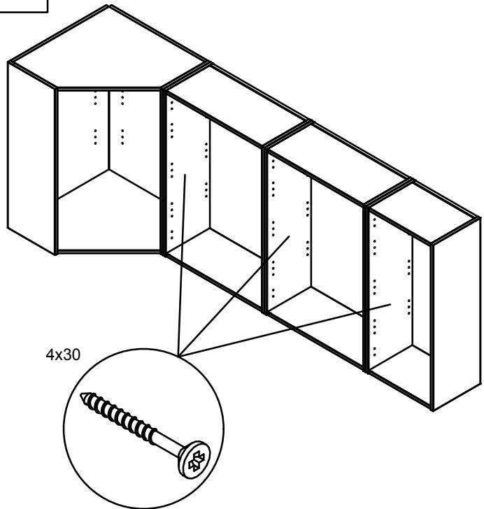
Kiinnitä kaapit lattialla toisiinsa 4x30 ruuveilla, 4 kpl / kaappipari. (Kiinnikkeet eivät sisälly toimitukseen)
