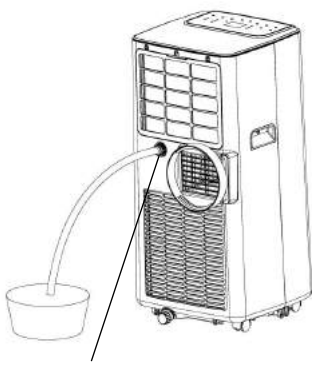
Salida drenaje continuo
