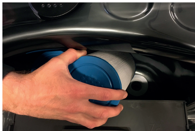
STEG 2 Vrid ur spabadets tre filter och rengör enligt tidigare anvisning i detta avsnitt.
